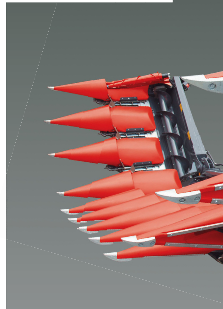
Система „анти шок“ – при контакте с землей делители автоматически откидываются вверх, оставаясь невредимыми.
