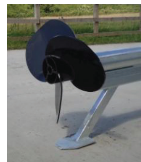
Резиновая гофрированная опора, смазываемая навозом и обеспечивающая минимум обслуживания
