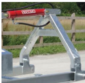
Гидравлическое соединение, как правило, сверху
