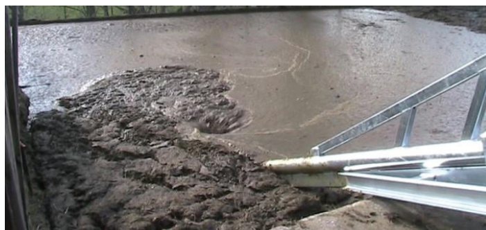
Тяжелонагруженный коробчатый профиль упрочняет смесительную трубу
